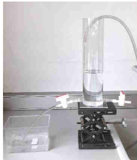
Abb. 9: Der Wasserspiegel im Behälter steigt so lange, bis sich ein Fließgleichgewicht einstellt.
