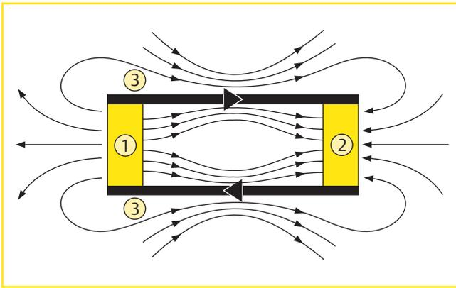
Abb. 6: Der Energiestrom von einer Batterie zu einem Widerstand längs widerstandsfreier Drähte.
