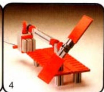
Links strömt die Energie durch eine runde Eisenwelle, rechts durch eine Plastikwelle mit viereckigem Querschnitt.
