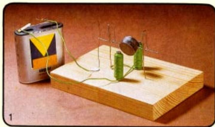
*Die Motorwelle: Biege eine Büroklammer so auf, daß ein Stück gerader Draht entsteht. Befestige an diesem Draht mit Klebeband oder Klebstoff die Dauermagnete. Die beiden Nordpole müssen in dieselbe Richtung weisen, und die beiden Südpole in die entgegengesetzte Richtung, Bild 3 oben. Die Aufhängung für die Motorwelle bilden zwei aufgebogene Büroklammern, die auf dem Holzbrettchen befestigt werden. Verbiege das eine Ende*
