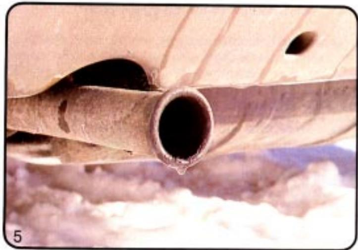
Im Auspuffrohr sammelt sich eine Flüssigkeit.
