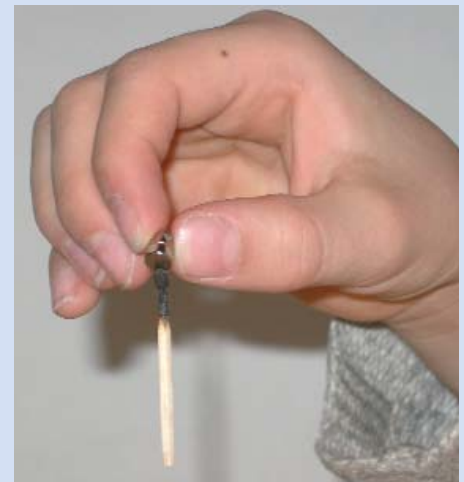
Abb. 6: Durch das Abbrennen kann ein Streichholz magnetisch werden.
