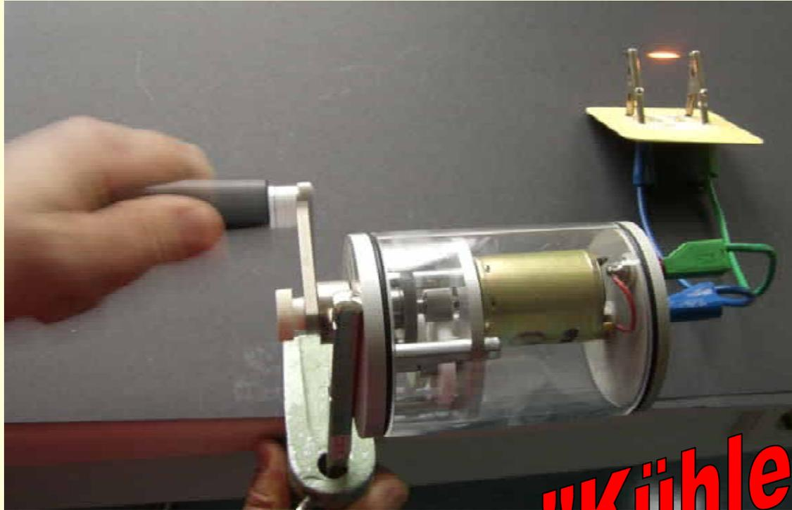
Eine Bleistiftmine wird zwischen zwei Klappstiften gespannt, einer Dynamot angeschlos, er wird so lange gedreht bis sie glüht (Film)
